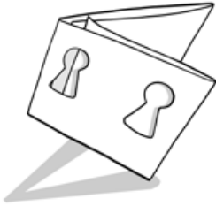
Geschlossener Fensterfalz mit figürlicher Stanzung.
